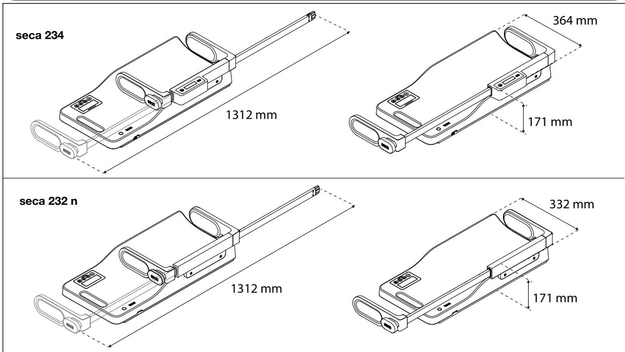
• Waage vorbereiten • Preparing scale • Préparation de la balance • Preparazione della bilancia • Preparar la báscula
